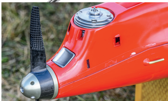
De propeller in koolstofvezel, samen met de hub gemald, is bestemd voor 32.500 tr/min.
